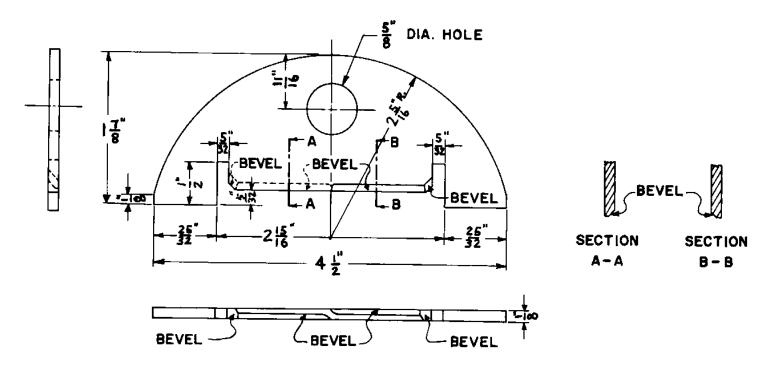
FIG. 1. TOOL FOR LEVELING SEALING COMPOUND IN THE SHRINKAGE TEST SPECIMEN.
